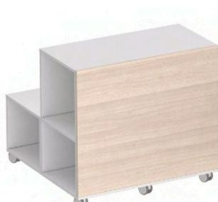
Il est fabriqué en panneau aggloméré de particules de 19 mm d'épaisseur recouvert en mélamine de 120 g/m<sup>2</sup> pour les deux côtés et une densité de 630 ± 5 kg/m<sup>3</sup>. Des chants extérieurs en ABS 2mm d'épaisseur collés avec colle thermofusible et arrondis.
