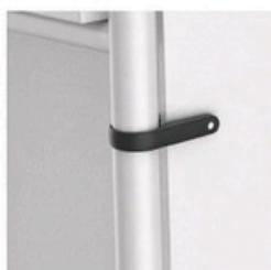
Le panneau avant est fixé à la structure métallique à l'aide de **4 pinces** noires en polypropylène avec fibre de verre, d'un écrou hexagonal et d'une vis et une vis DIN 912 M5x14 zingués blancs.
