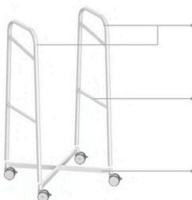
**Latéraux** métalliques en forme de "U" inversé en tube cintré d'acier laminé à froid de Ø30 x 2 mm découpés et usinés au laser.
