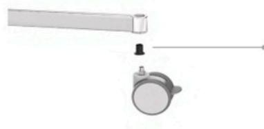
À chaque extrémité, il y a des tubes ronds de Ø30 x 2 mm soudés où sont placés des **embouts** en polyamide noirs avec écrou métallique M8.
