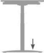
**Base** fabriquée en tôle d'acier 2 mm d'épaisseur, fixée à la colonne par des vis DIN-912 M8x20.
