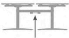
Pour l'ensemble des **bureaux vis à vis** sont utilisés deux renforts en tube d'acier rectangulaire 60x40 mm et 2 mm d'épaisseur.
