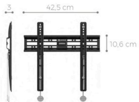
Support fabriquée en tôle laminée à froid d'acier de 1,5 mm d'épaisseur composé d'une plaque de base de 425 x 106 mm et de deux supports métalliques perforés de 406 x 36 mm.
