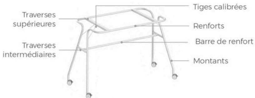
**Piétements métalliques** en forme de "V" inversé en tube cintré d'acier laminé à froid composés de traverses, montants et tiges calibrées.
