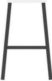
Structure métallique de tubes d'acier rectangulaires, laminés à froid de 30 x 15 mm et d'épaisseur 1,5 mm.
