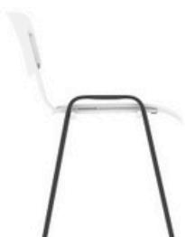
Structure métallique à 4 pieds fabriquée en tube ovale d'acier laminé à froid de 30 x 15 mm et d'épaisseur 1,5 mm.
