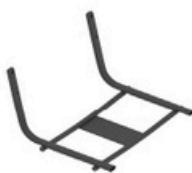
Cadre noir pour la monocoque monobloc fabriquée en tubes d'acier laminés à froid de Ø25 mm et d'une épaisseur de 1,5 mm.
