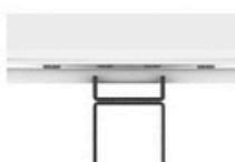
La chaise est fixée à la barre de la poutre à l'aide d'une bague de serrage noire en forme de U d'une épaisseur de 4 mm.
