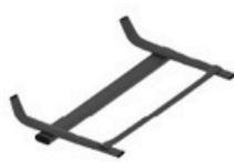
Cadre noir pour la monocoque monobloc fabriquée en tubes d'acier laminés à froid de Ø25 mm et d'une épaisseur de 1,5 mm.
